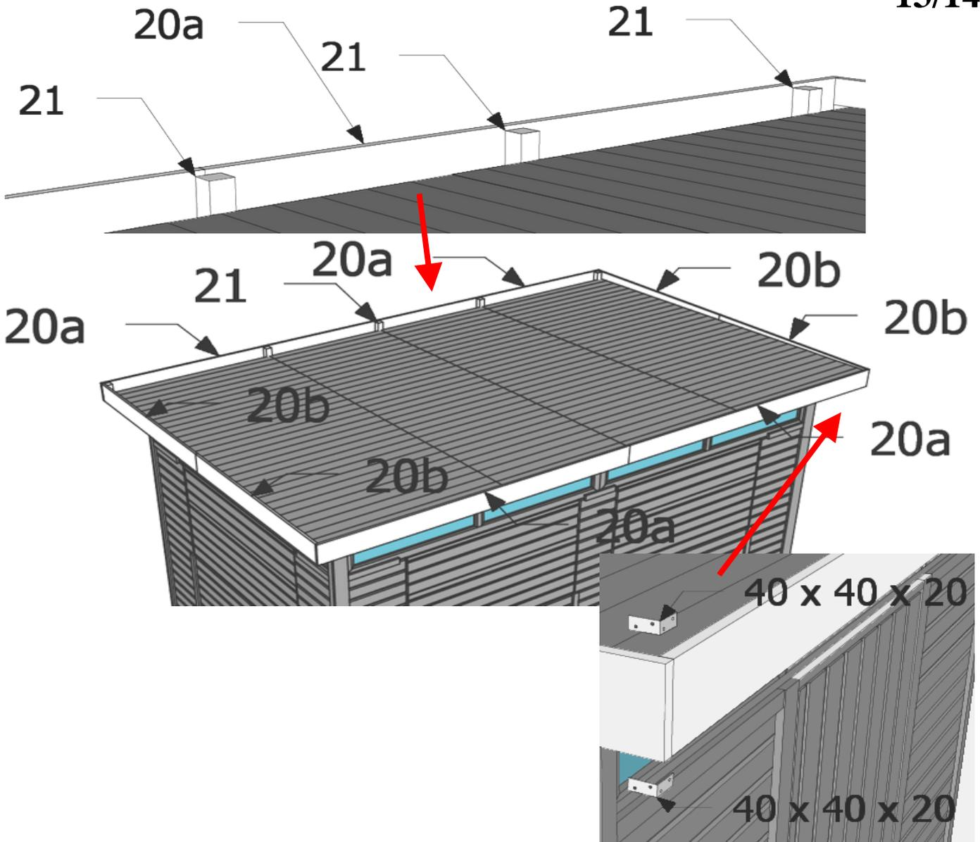
+10 (roof edge / Dachseite) →
