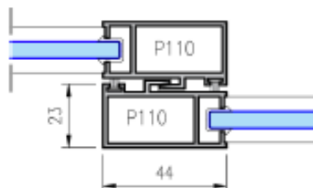
Bild 5: Korrekt monterade dörrar
