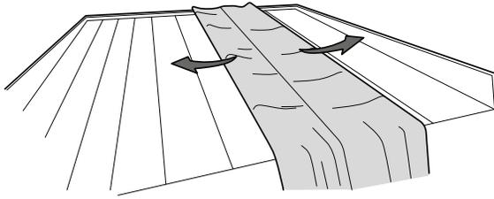
Placer la piste EPDM sur le toit et l'étaler. Peut également être utilisé à l'avance comme imperméabilisation provisoire du toit.
