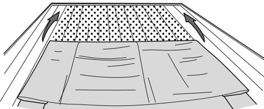
Travailler la bande EPDM le plus possible sans plis à partir du centre dans la surface adhésive encore humide. (Il n'y a pas de temps d'aération !)
