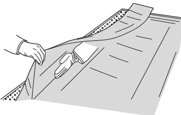
Travailler les zones marginales avec la main plate de l'intérieur vers l'extérieur jusqu'à la gorge, puis travailler sur le panneau jusqu'au bord supérieur.
