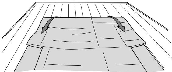
Replier la bande EPDM d'un côté.
