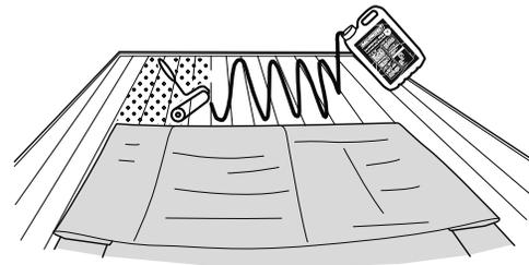
L'adhésif de surface Bluetek ne peut être basculé dans les boucles que sur le support en bois et réparti uniformément avec le rouleau.
