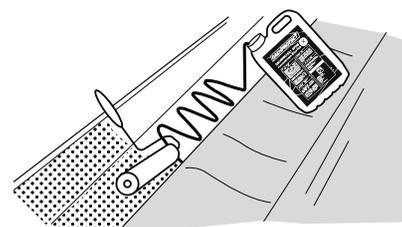
L'adhésif de surface Bluetek ne peut être basculé dans les boucles que sur le support en bois et réparti avec le rouleau sur les zones marginales, y compris le cache.
